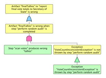
Fig. 10. MCS-2's mini fault tree
